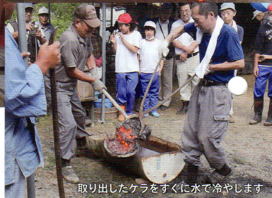
たたら炉を解体し“ケラ”を取り出します
