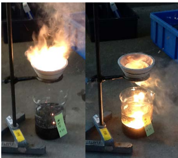
図 7. 電気炉内で砂鉄および砂を 1200°Cで加熱溶解した。二酸化ケイ素が多いと粘性の高いガラス質に固化される。大気中の融解のため、砂鉄は酸化され磁性は消失するが、二酸化ケイ素の量が多く含まれる場合はわずかに磁性が残る。左から島根砂鉄(4.44g/cm 3 )、鎌倉砂鉄(3.70g/cm 3 )、鎌倉海岸の砂(3.17g/cm 3 )。
