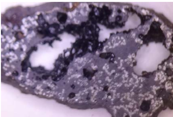
図 2. 過剰の二酸化ケイ素の中に鉄が存在しているのが観察できる。
