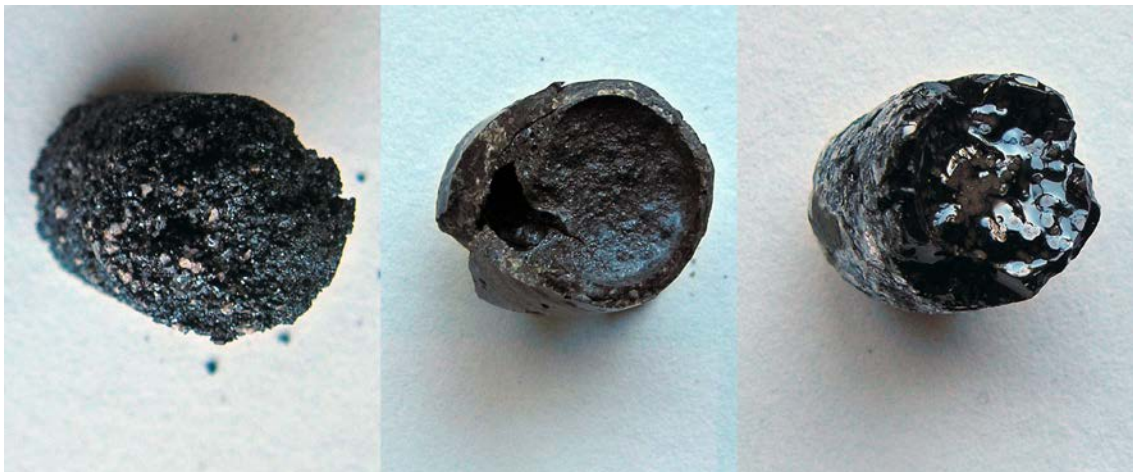
図 7. 電気炉内で砂鉄および砂を 1200°Cで加熱溶解した。二酸化ケイ素が多いと粘性の高いガラス質に固化される。大気中の融解のため、砂鉄は酸化され磁性は消失するが、二酸化ケイ素の量が多く含まれる場合はわずかに磁性が残る。左から島根砂鉄(4.44g/cm 3 )、鎌倉砂鉄(3.70g/cm 3 )、鎌倉海岸の砂(3.17g/cm 3 )。
