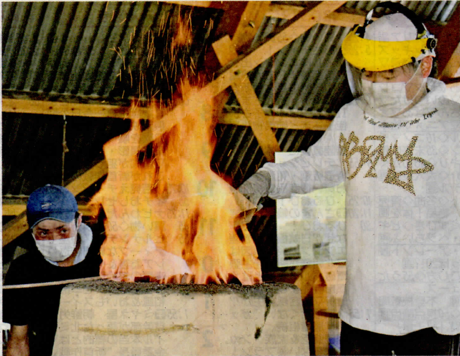
たたら製鉄の炉に砂鉄と木炭を投入する大原小6年生
