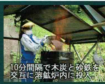
約5時間、1400～1500℃の炉に投入し続けます。
