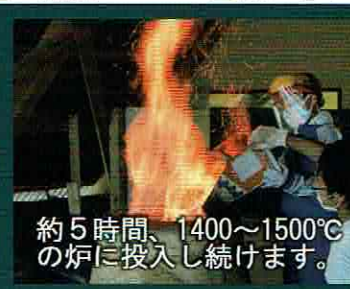
10分間隔で木炭と砂鉄を交互に溶鉱炉内に投入。
